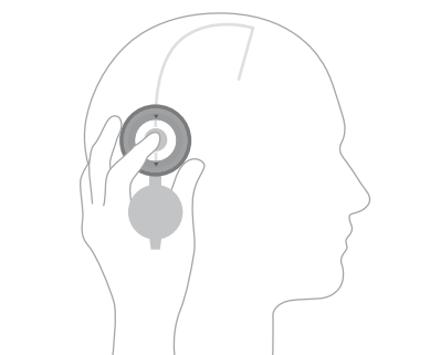
Fig. 9: localização da válvula com o compasso M.blue plus
